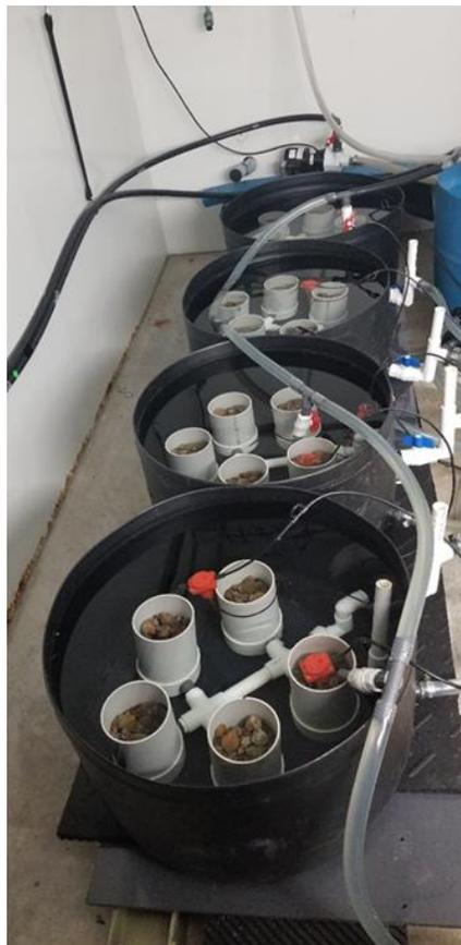
Figure 6. Dispositif expérimental, avec quatre bassins sur la plate-forme vibrante, avec un renouvellement constant de l'eau. Le groupe témoin n'apparaît pas sur l'image, il a été placé plus loin dans la pièce pour éviter les vibrations de l'appareil.
