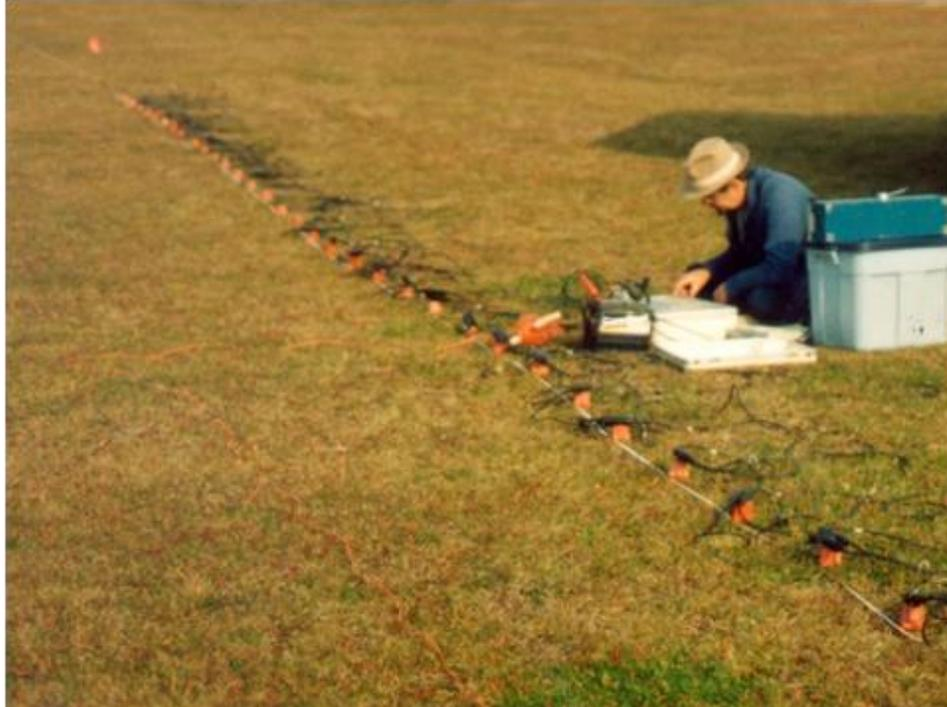
Figure 3. Géophones utilisés pour l'enregistrement des vibrations du sol.
