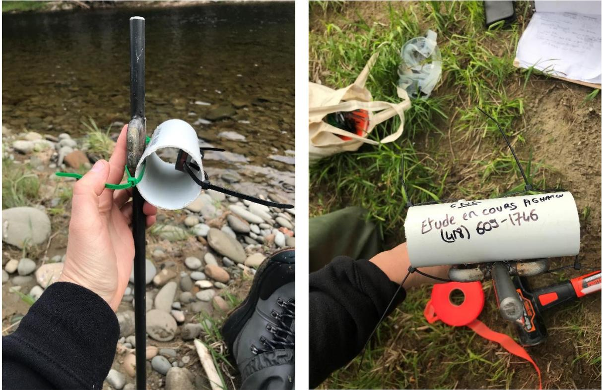
**Figure 6:** Installation pour les thermographes en rivière (Rivière Malbaie, 2023).
